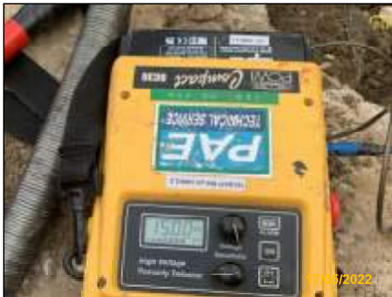
ค) การทดสอบหารอยรั่วในวัสดุเคลือบผิว Holiday Test
